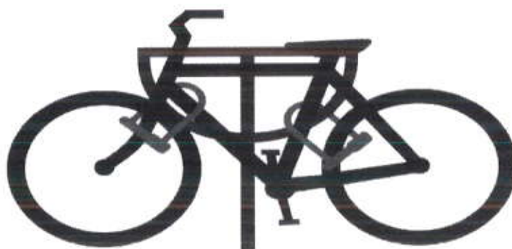
Figura 86. Exemplu de rastel care permite securizarea ambelor roți și a cadrului
